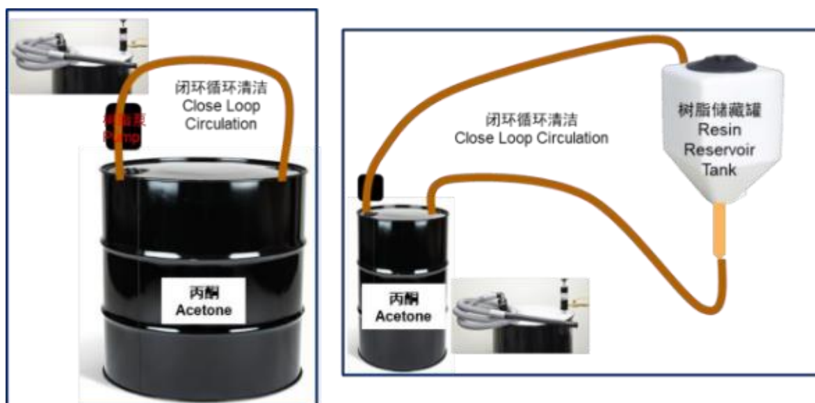
图3.7-1 树脂泵（左）和树脂系统（右）的闭环清洁过程示意图
